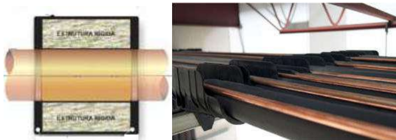
Figura 5: Sistema de sustentação das linhas de fluido
